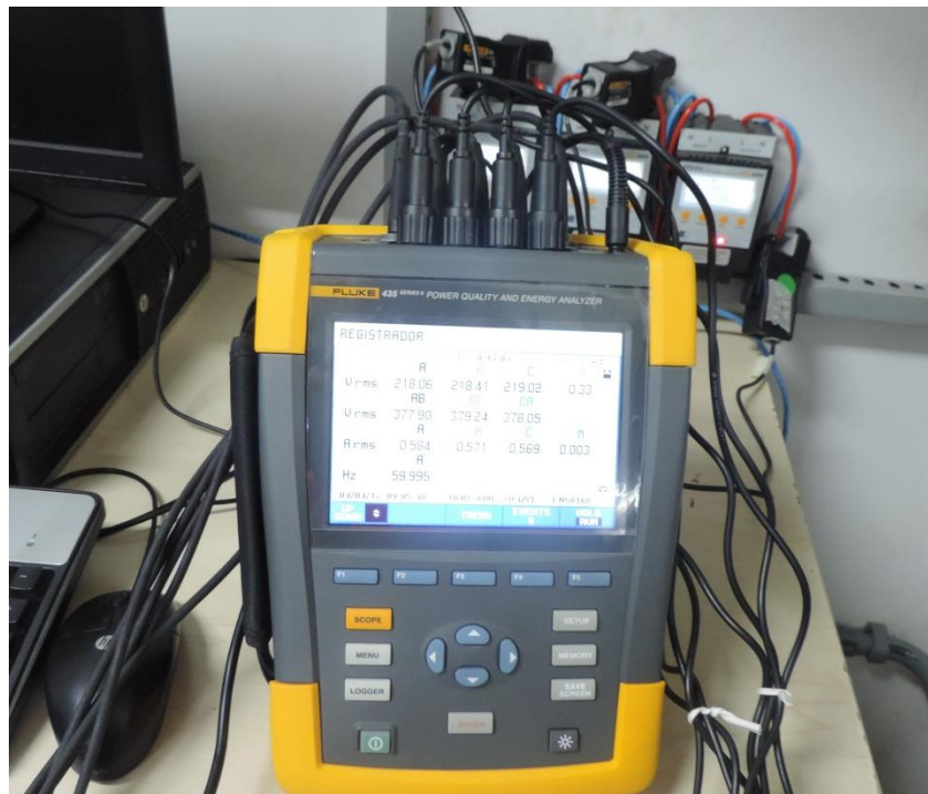
Figura 15 – Analisador de grandezas elétricas Fluke 435 série II
